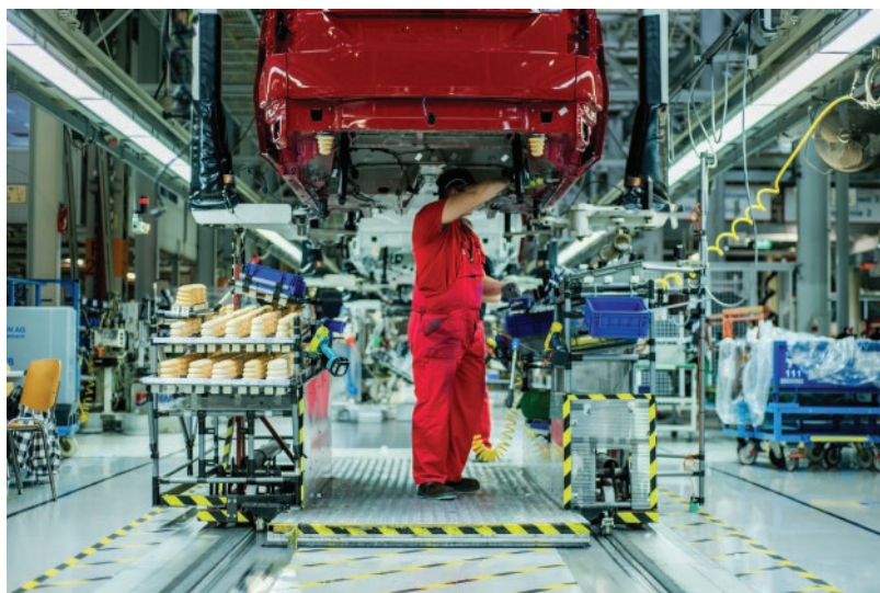
Platforma jezdna zainstalowana w hali montażu eliminująca zbędny pieszny ruch pracowników, pobierających części z pojemników Fot. archiwum firmy VW
